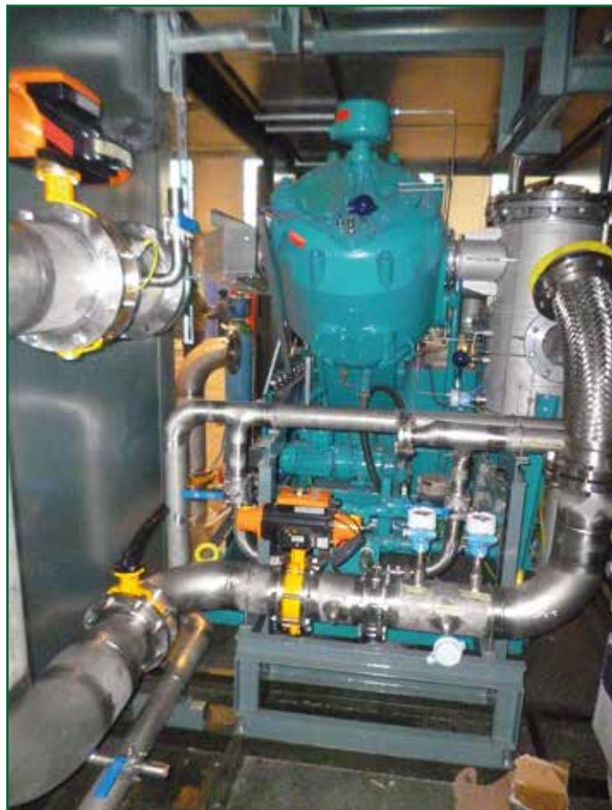
**Figura 6 – Compressore gas.**
