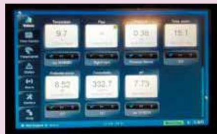
rete di sonde/analizzatori in continuo per garantire il controllo da remoto della qualità dell'acqua. I 32 pozzi hi-tech diventeranno 60 entro fine anno, con l'obiettivo di estendere in tempi rapidi l'applicazione della nuova tecnologia su tutto il territorio gestito da Gruppo CAP. I vantaggi: prevenire e gestire al meglio le eventuali criticità, a tutto vantaggio della qualità dell'acqua del rubinetto.
