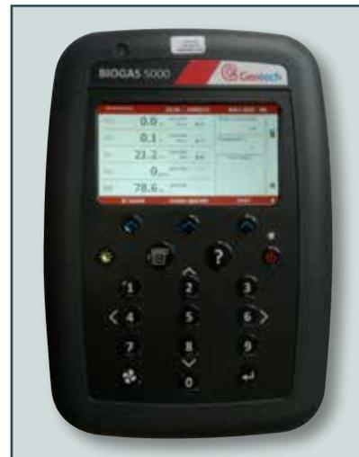
**Figura 1 – Analizzatore di Biogas GA5000.**
