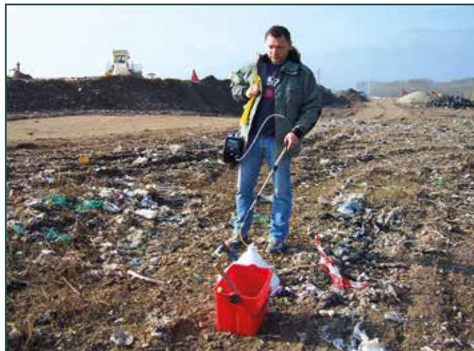
**Figura 2 – Analisi della superficie della discarica mediante Flux Box.**
