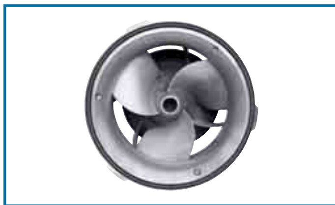
Figura 3 - Il cono di aspirazione è realizzato in Hard Iron™ per la massima resistenza all'usura ed è dotato della particolare scanalatura tipica della tecnologia N che, insieme al profilo palare dell'elica, permette il passaggio di solidi filamentosi senza rischi di bloccaggio. Inoltre è predisposto per l'adozione di anodi di zinco, opportunamente sagomati, per non disturbare il flusso del liquido e contrastare efficacemente la corrosione.
