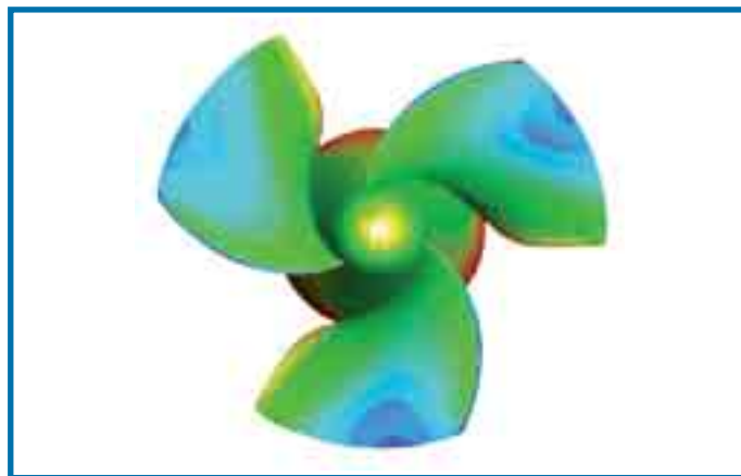
Figura 2 - Lo studio dell'elica della pompa, realizzata in una fusione in AISI 316, ha permesso un'ottimale distribuzione dei campi di pressione a totale vantaggio dell'affidabilità e dell'efficienza del pompaggio.
