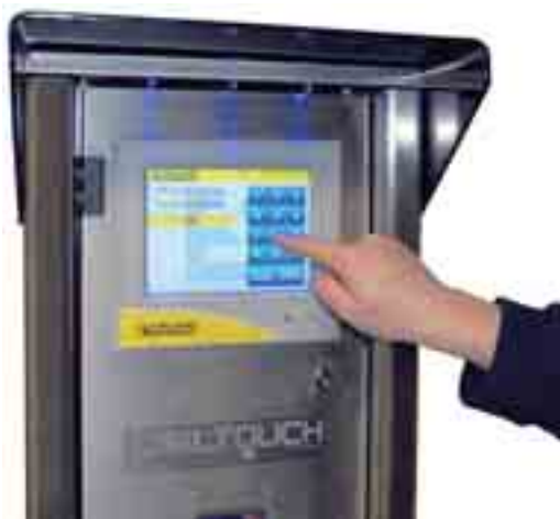
Figura 2 - Emiltouch è costituito da un modulo integrato di tipo touch-screen.
