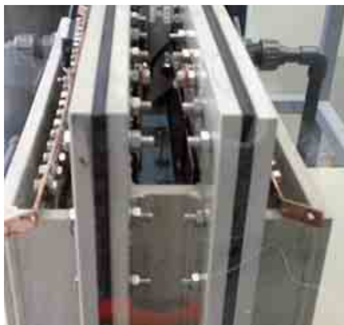
Figura 2 – La cella è costituita in materiale plastico, divisa in tre o più settori separati da una membrana conduttiva.
